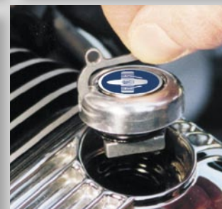
La parte superiore gira a vuoto. Apribile solo con chiave.
